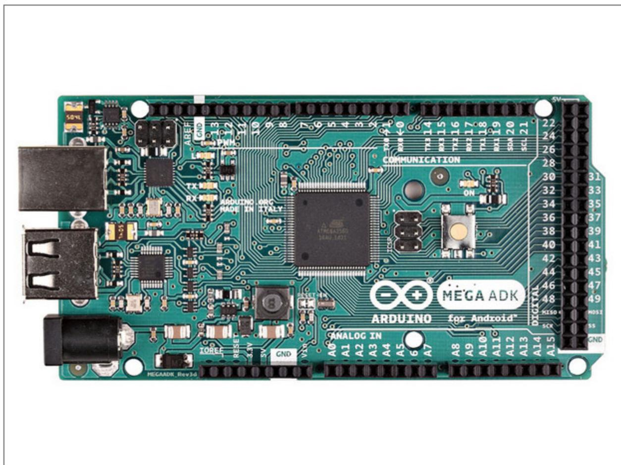
L'Arduino Mega ADK è una scheda basata sul microcontrollore ATmega2560. Ha un'interfaccia host USB per collegare dispositivi Android, basato sul MAX3421E. Dispone di 54 pin digitali di ingresso/uscita (di cui 15 possono essere utilizzati come uscite PWM), 16 ingressi analogici, 4 UART (porte seriali hardware), un oscillatore a 16MHz, una connessione USB, un connettore di alimentazione, un connettore ICSP ed un pulsante di reset.
